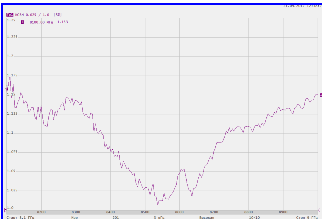
Рис. 10. Коэффициент стоячей волны рупорной антенны с линейной поляризацией
