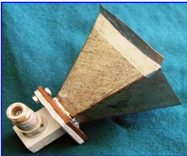
Рис. 9. Опытный образец рупорной антенны с линейной поляризацией
