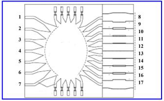
Рис. 3. Диаграммообразующая схема
