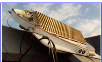
Рис. 27. Гибридная активная фазированная антенная решетка системы спутниковой связи
