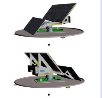
Рис. 20. Виды макета антенной системы мобильного терминала спутниковой связи, размещённого на опорно-поворотной платформе: a — вид спереди;  $\delta$  — вид сзади
