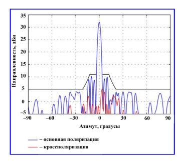
Рис. 41. Диаграмма направленности антенной решетки в азимутальной плоскости, рассчитанная на частоте 11,7 ГГц в режиме передачи при 30° отклонении от горизонта
