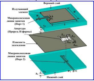
Рис. 4. Модель прямоугольного печатного излучателя с двойной поляризацией, возбуждаемого через щель
