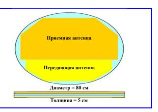
Рис. 18. Размеры и геометрия антенной системы
