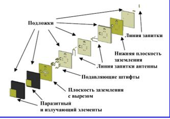
Рис. 23. Структура элемента антенной решетки
