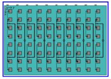
Рис. 2. Модель микрополосковой антенной решетки спутниковой связи с широкоугольным механическим сканированием
