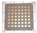
Рис. 1. Фотография микрополосковой фазированной антенной решетки
