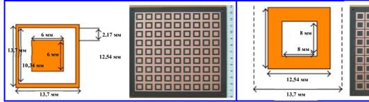
Рис. 15. Верхний слой частотно-селективной поверхности
