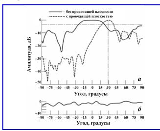
Рис. 11. Измеренные на частоте 19 ГГц диаграммы направленности: a – в H-плоскости;  $\delta$  – в E-плоскости
