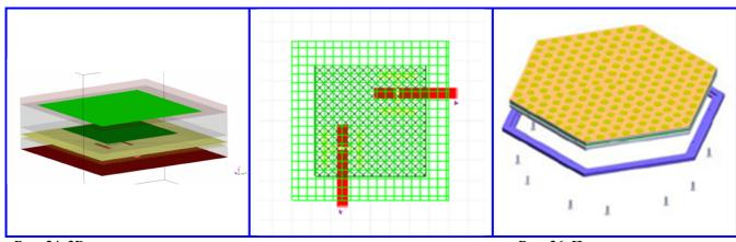
Рис. 24. 3D-модель микрополосковой антенны
