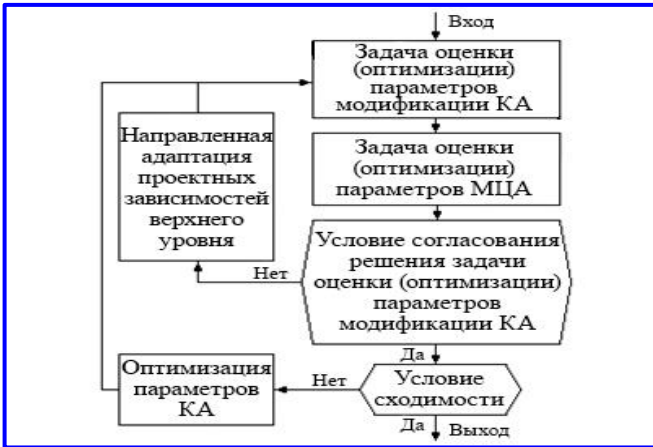
Рис. 4. Блок-схема алгоритма двухуровневой согласованной оптимизации (оценки) параметров модификации космического аппарата при модернизации системы к моменту времени t_i
