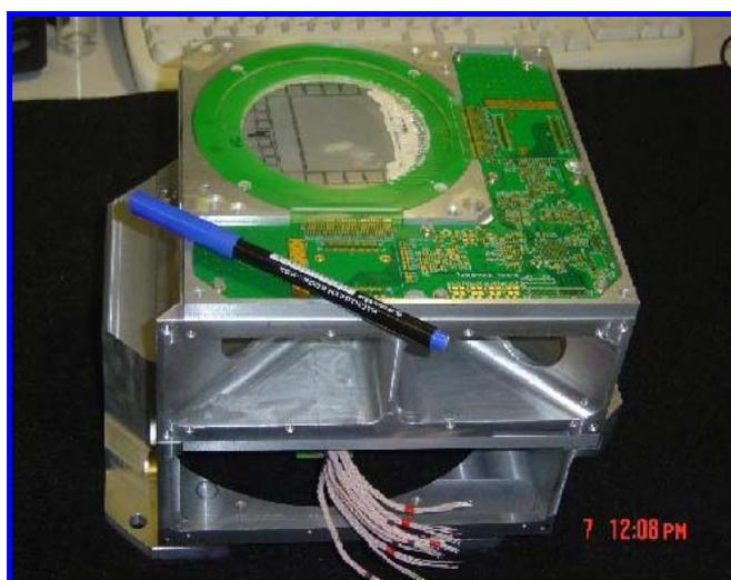
Рис. 5. Внешний вид электроники спектрометра в процессе сборки
