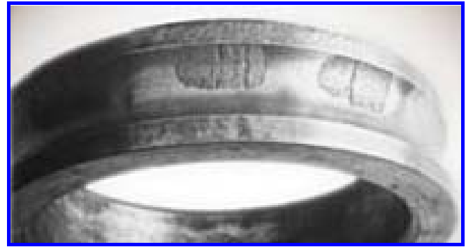
Рис. 1. Характерный износ дорожки внутреннего кольца подшипника, работавшего в качательном режиме
