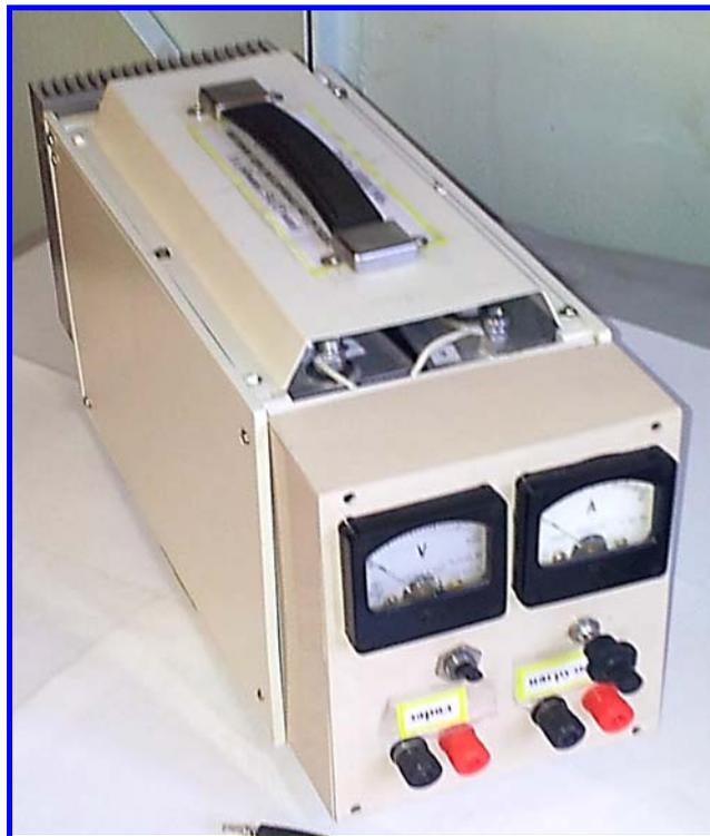
Рис. 2. Общий вид источника вторичного электропитания на основе БИ 18 В, 437 Ф из 8 шт. ионисторов К58-21-2,3В-3500Ф и DC-преобразователя 27 В серии MR160D-12WS-UM
