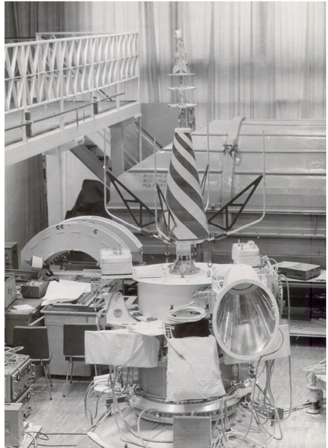
**Рис. 4. Приборный отсек при сборке КА «Метеор-Природа» № 3-1**
