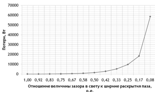
Рис. 6. Добавочные потери турбогенератора в зависимости от  $k_{bn}$
