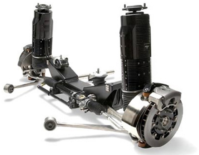
Рис. 11. Линейные электродвигатели в подвеске автомобиля
