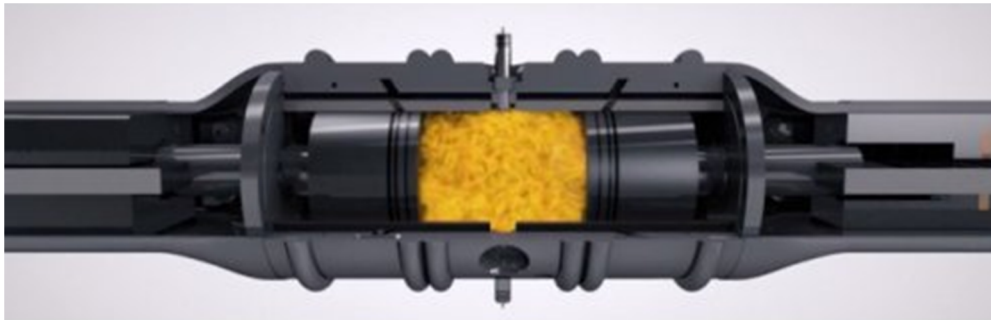
Рис. 14. Двигатель с двумя поршнями и центральной камерой сгорания
