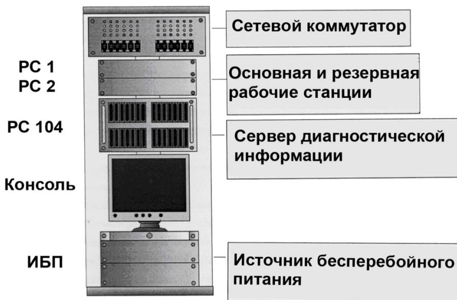
Рис. 1. Структурная схема ИДККСН ЭКСПРО
