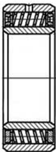
Рис. 5. Роликовый радиальный подшипник с витыми роликами
