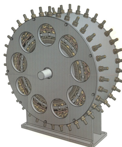
Рис. 6. Катящийся токосъём с разрезной обоймой: а – схема, б – 3D вид токосъёма
