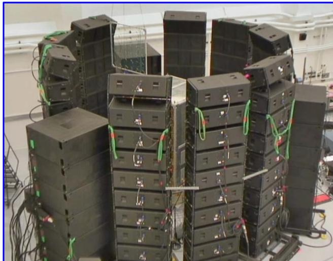
**Экспериментальная установка [6] для испытаний изделий РКТ (на стойкость к воздействию звуковых волн высокой интенсивности) с использованием метода DFAT**
