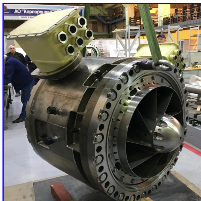
Рис. 1. Циркуляционный электронасос ГЭН-300 с регулируемой частотой вращения
