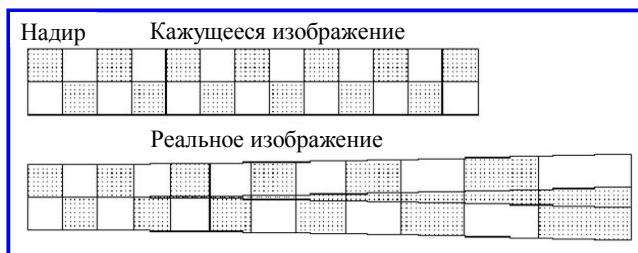
Рис. 16. Кажущееся изображение, т. е. без проецирования на реальную Землю, и реальное, получающееся в результате проецирования «квадратных» ФЧЭ (пикселей) ФПЗС на поверхность Земли [46]
