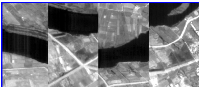
Рис. 1. Фрагмент изображения в градациях серого от ФПЗС ОЭА, расположенных в «шахматном порядке» [33]
