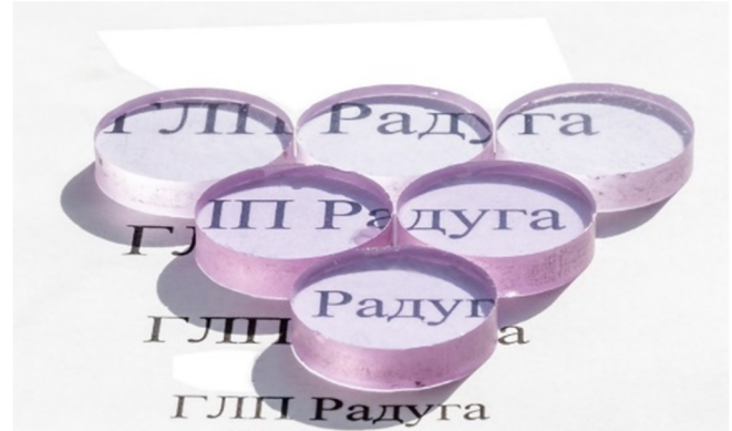
Рис. 15. Образцы лазерной нанокерамики Y_3Al_5O_{12}:Nd^{3+} (толщина – 4 мм, диаметр – 19 мм)
