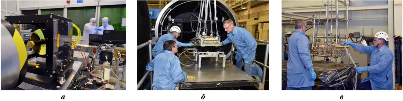
Рис. 1. Тестирование оптического тракта (а), термовакuumные (б) и виброиспытания (в) лазерной системы связи LCRD (фото NASA) [3]
