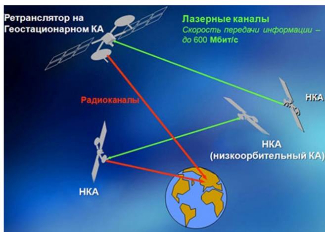
Рис. 6. Схема функционирования межспутниковых лазерных систем передачи информации со скоростью до 600 Мбит/с и дальностью действия от 1 до 6 тыс. км по линии НКА – НКА и от 30 до 46 тыс. км по линии НКА – ГКА [9]
