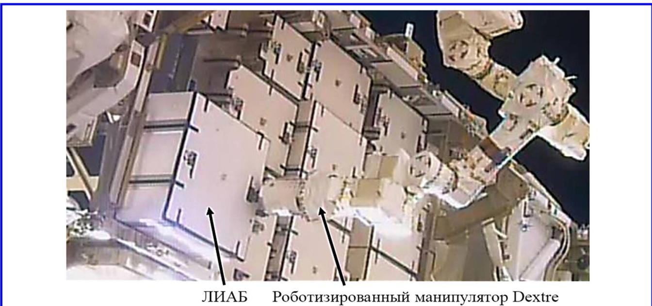
Рис. 3. Роботизированный манипулятор с питанием от литий-ионной аккумуляторной батареи на МКС [5]
