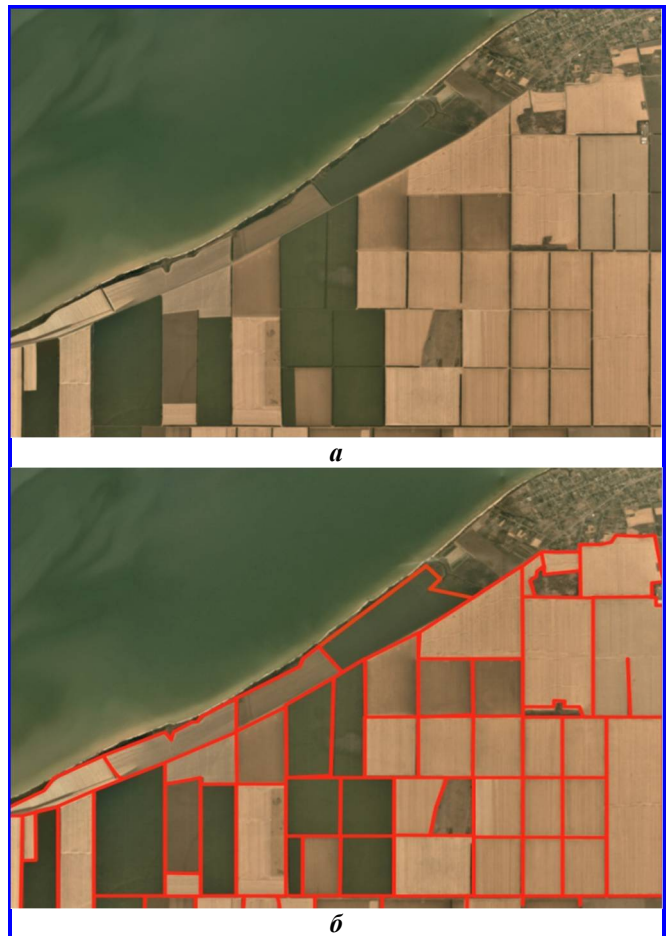
Рис. 6. Выделение сельскохозяйственных угодий на базе данных PlanetScore с помощью нейронной сети U-Net: а – спутниковый снимок; б – результат сегментации
