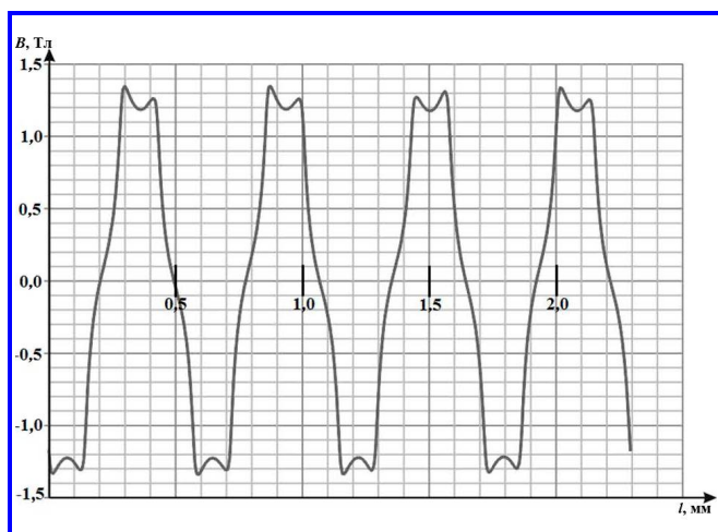
Рис. 5. Зависимость магнитной индукции B в воздушном зазоре имитатора магнитной индукции от координаты l
