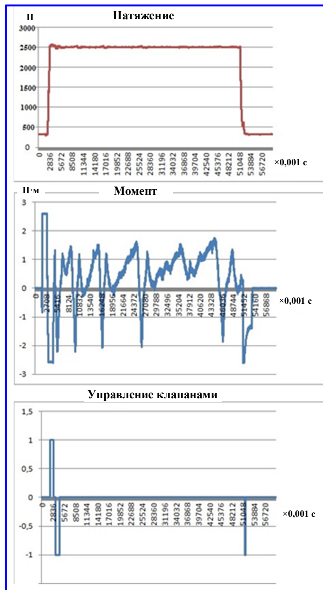
Рис. 12. Результаты испытаний электропривода механизма намотки
