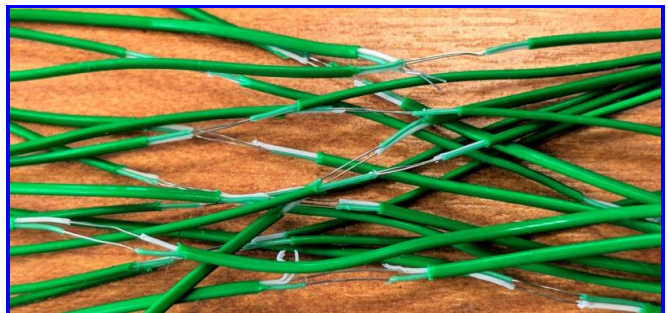
Рис. 3. Удаление изоляции термопары ПТФФ ХА на длине участка герметизации
