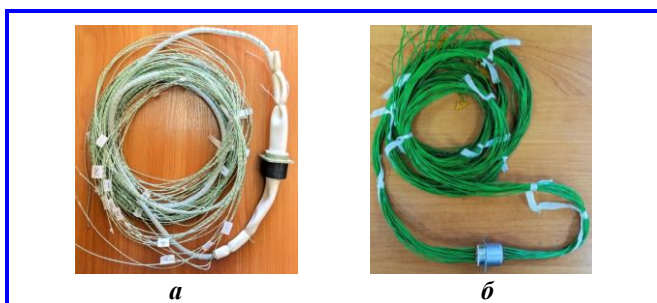
Рис. 6. Рабочий образец гермоввода с термопарами ТХА (а) и ПТФФ ХА (б)
