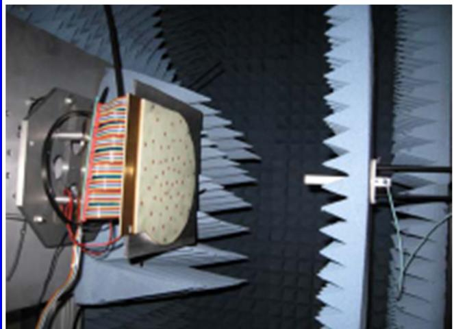
Рис. 14. Фотография антенны на измерительном стенде
