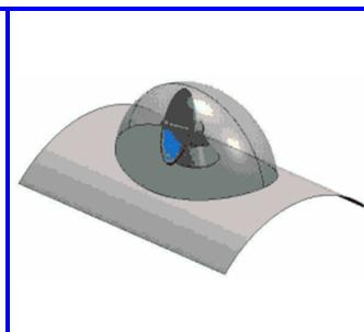
Рис. 32. Зеркальная антенна с механическим сканированием
