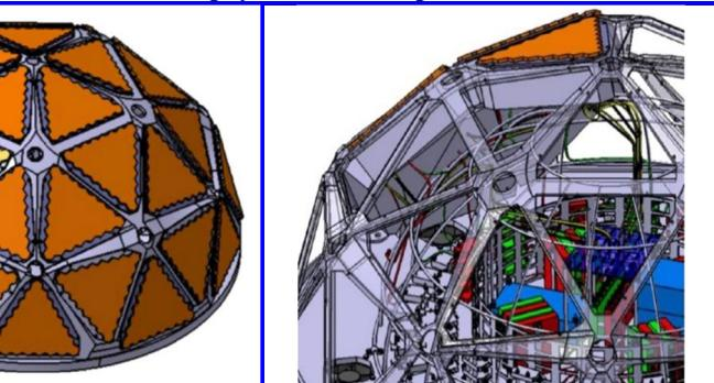
Рис. 39. Полусферическая антена, собранная из подрешеток
