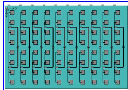
Рис. 2. Модель микрополосковой антеннной решетки спутниковой связи с широкоугольным механическим сканированием
