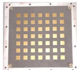
Рис. 1. Фотография микрополосковой фазированной антеннной решетки
