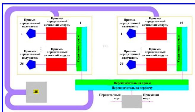
**Рис. 42. Система формирования и управления лучом**
