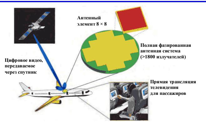
Рис. 28. Иллюстрация работы бортовой системы спутникового телевещания
