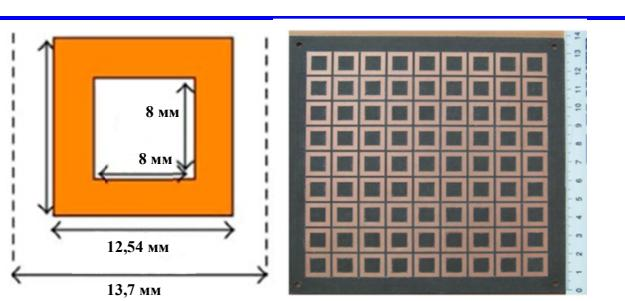
Рис. 16. Нижний слой частотно-селективной поверхности
