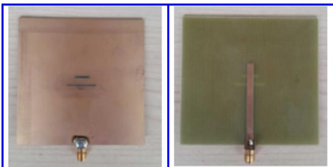
Рис. 6. Фотография экрана со щелями
