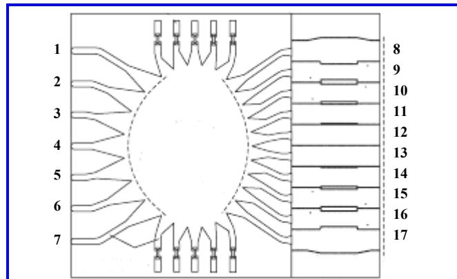
Рис. 3. Диаграммообразующая схема
