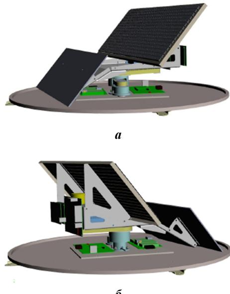
Рис. 20. Виды макета антенной системы мобильного терминала спутниковой связи, размещенного на опорно-поворотной платформе:
