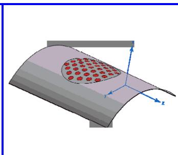
Рис. 33. Антennaя решетка с электрическим сканированием
