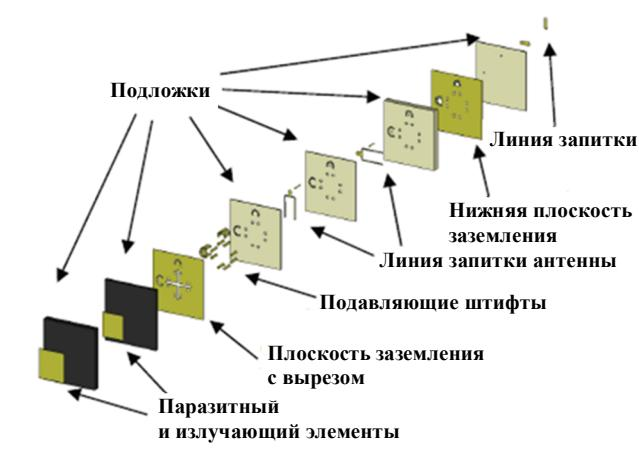
Рис. 23. Структура элемента антенной решетки
