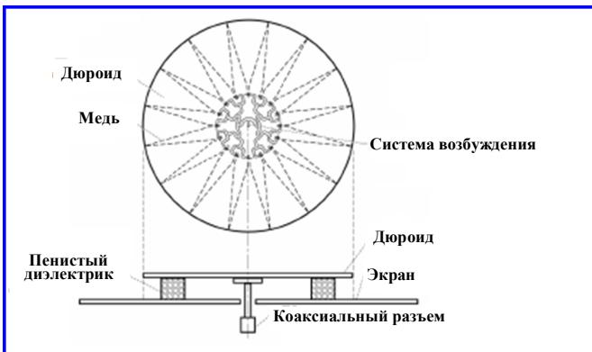
Рис. 10. Кольцевая антенная решетка из 16-ти щелевых излучателей с линейно расширяющейся щелью
