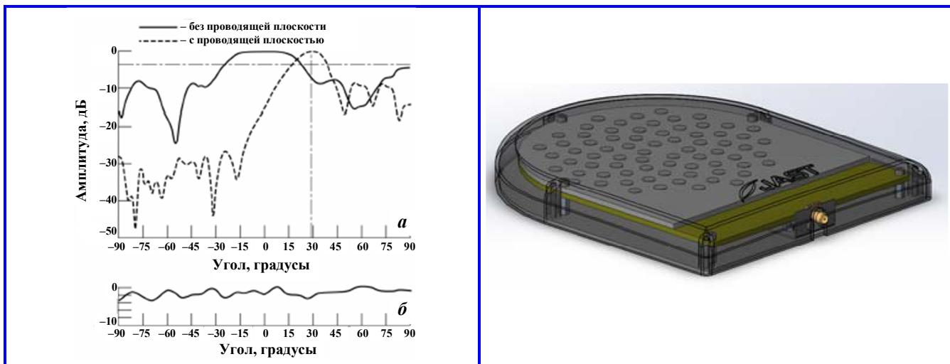
Рис. 11. Измеренные на частоте 19 ГГц диаграммы направленности: *а* – в Н-плоскости; *б* – в Е-плоскости
