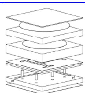
Рис. 31. Покомпонентное изображение излучающего элемента
