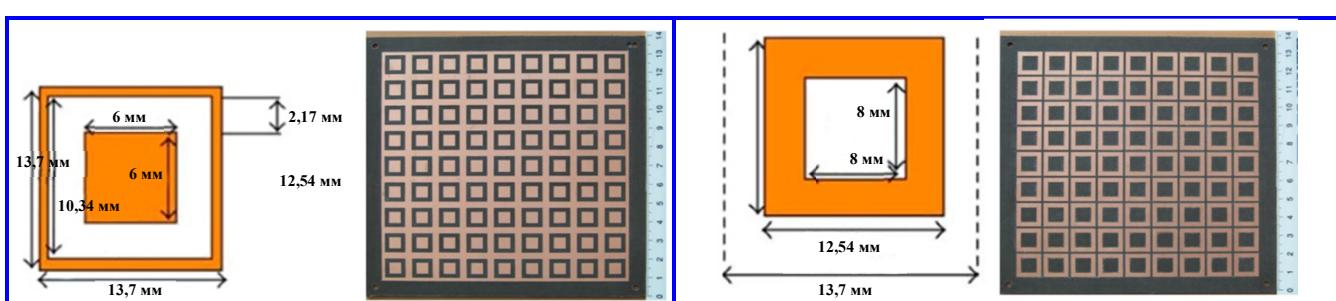
Рис. 15. Верхний слой частотно-селективной поверхности
