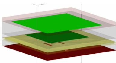
Рис. 24. 3D-модель микрополосковой антенны
