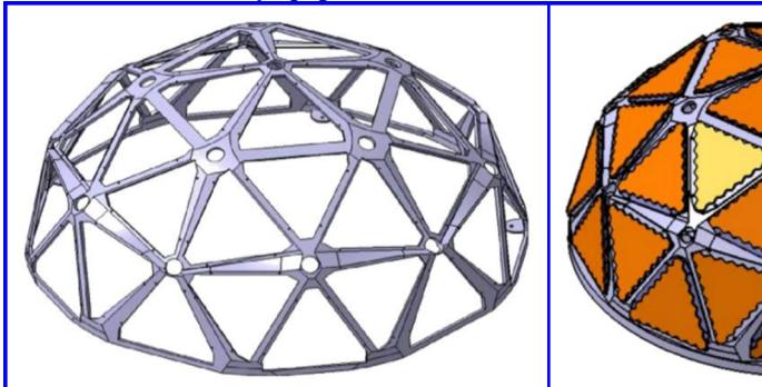
Рис. 38. Каркас для крепления подрешеток
