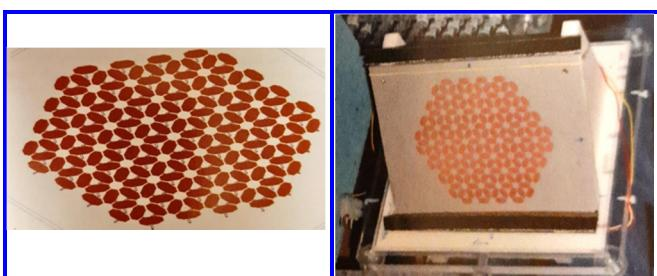
Рис. 8. Структура антенного полотна
