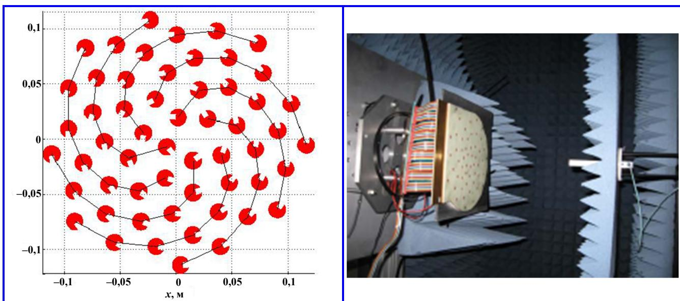
Рис. 13. Спиральная схема размещения элементов
