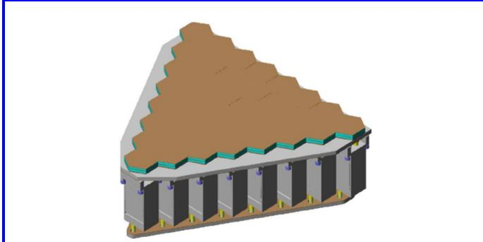
Рис. 36. Треугольная подрешетка полусферической антены
