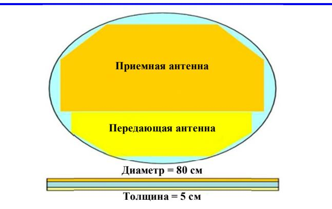
Рис. 18. Размеры и геометрия антенной системы
