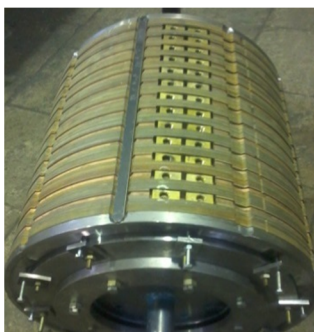
Рис. 5. Фото статора электрической машины с принудительным водяным охлаждением с применением тепловых элементов
