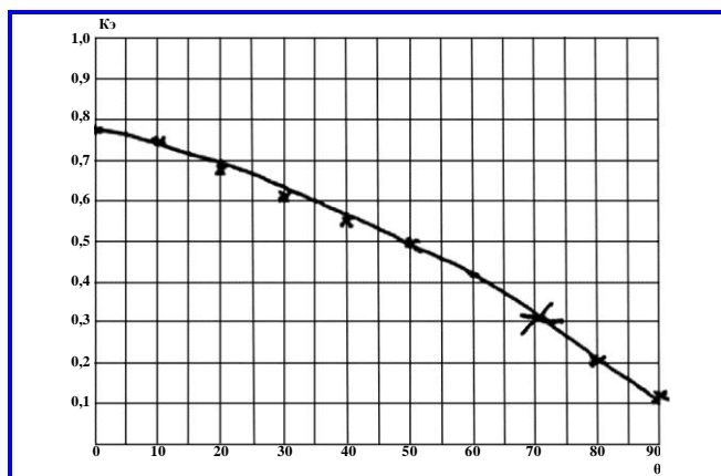
Рис. 7. Коэффициент эллиптичности передающего канала антенно-фидерного устройства телекомандной системы
