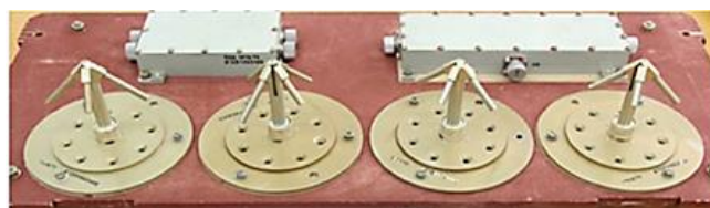
Рис. 4. АФУ ТКС для КА, спроектированных на базе космической платформы «Канопус-В» (без кабельной сети)
