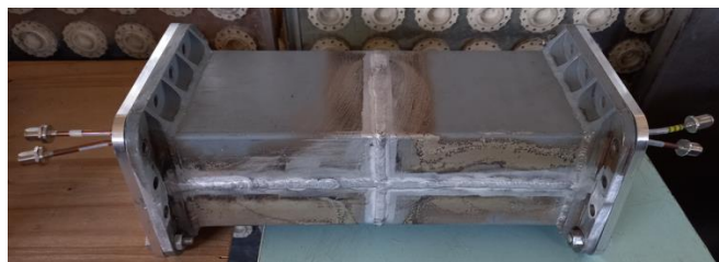
Рис. 1. Волновод с установленными излучателями
