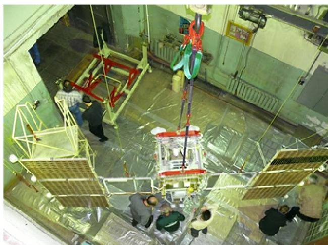
Рис. 5. ДМ КА «Канопус» во время испытаний
