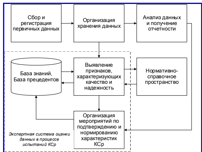
Рис. 3. Структура системы сбора, обработки и анализа данных о функционировании КСр
