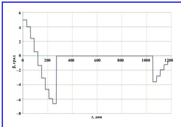
Рис. 5. Зависимость угла между вектором тяги и плоскостью оскулирующей орбиты от времени
