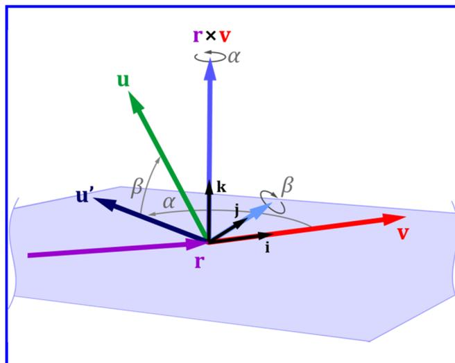
Рис. 1. Направление вектора тяги космического аппарата
