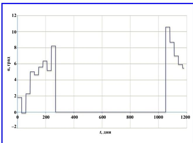
Рис. 4. Зависимость угла между вектором тяги и вектором скорости в плоскости оскулирующей орбиты от времени
