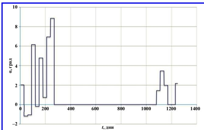
Рис. 8. Зависимость угла между вектором тяги и вектором скорости в плоскости оскулирующей орбиты от времени для  $t_0 = 19.11.2018$
