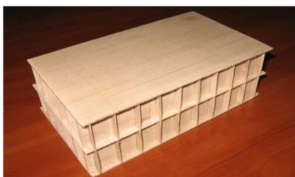
**Рис. 7. Фрагмент макета радиопрозрачного укрытия, выполненный из лакоткани марки Ф-4Д С ТС-8/3-К-0,28**
