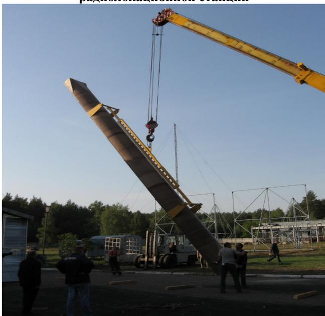
**Рис. 11. Испытания на прочность опытного образца секции радиопрозрачного укрытия полного состава для многофункциональной радиолокационной станции**
