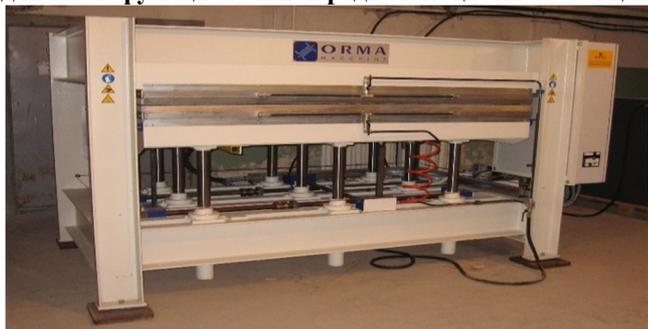
**Рис. 12. Гидравлический пресс горячего прессования Orma NPC Digit**
