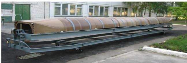
**Рис. 10. Опытный образец секции радиопрозрачного укрытия полного состава для передающей фазированной антенной решетки многофункциональной радиолокационной станции**
