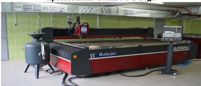
**Рис. 13. Установка гидроабразивной резки Water Jet Sweden**
