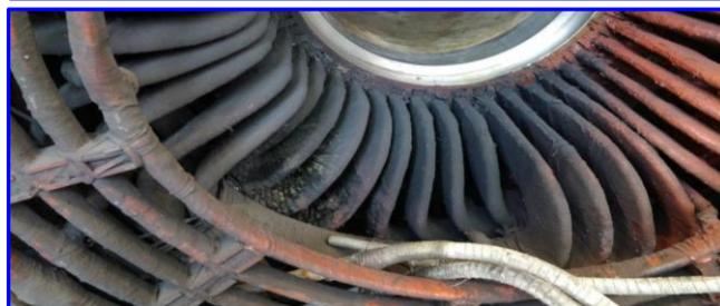
Рис. 1. Примеры повреждений обмотки статора
