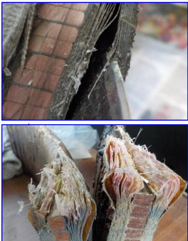
Рис. 3. Разрушение изоляции на основе стекломикаленты ЛМК-ТТ
