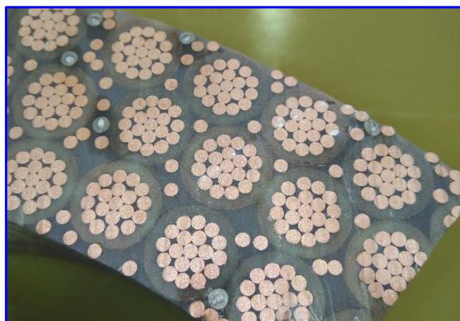
Рис. 4. Поперечный срез фрагмента изоляции обмотки на основе слюдинитовой ленты ЛСп-Н-ТПл по технологии «Монолит-1»
