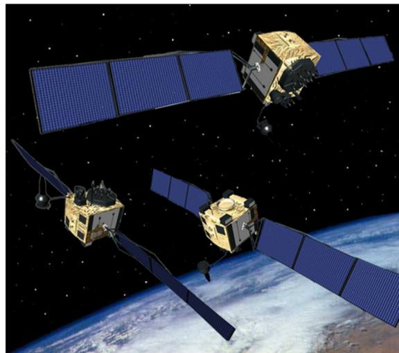
Рис. 3. Внешний вид космического аппарата GPS серии блока IIF
