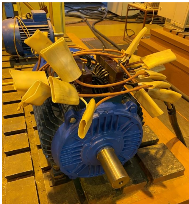
Рис. 16. Макетный образец шестифазного асинхронного двигателя
