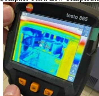
Рис. 4. Измерение температуры изделий с помощью тепловизора Testo 865
