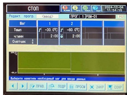
Рис. 3. Изображение интерфейса термальной камеры MC-812R Compact Ultra Low Temperature Chamber
