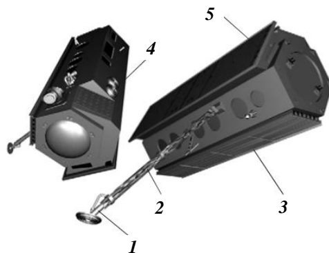
Рис. 14. Общий вид КА TerraSAR-X : 1 – антенна радиопередатчика; 2 – выносная штанга; 3 – антенна радиолокатора с синтезированной апертурой; 4 – GPS-приемник; 5 – солнечные батареи
