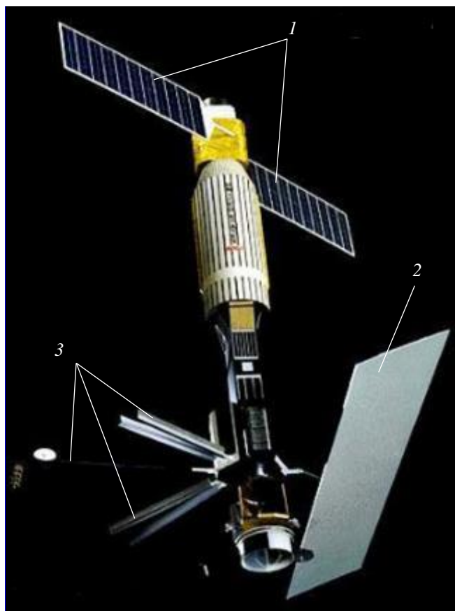
Рис. 1. Общий вид космического аппарата SEASAT : 1 – солнечные батареи; 2 – антенна радиолокатора с синтезированной апертурой; 3 – антенны скаттерометра
