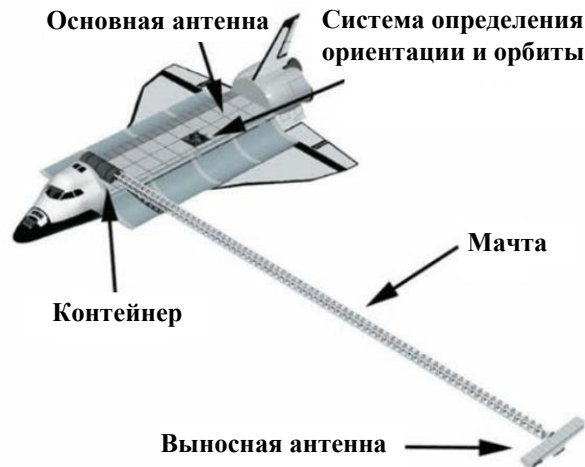
Рис. 8. Антенны радара SRTM на космическом корабле Endeavour
