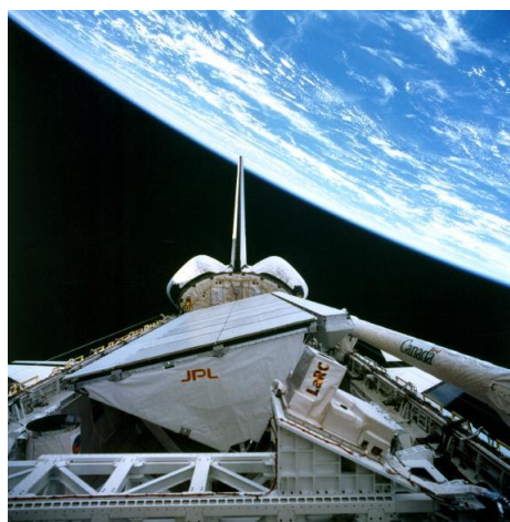
Рис. 5. SIR-C/X-SAR в грузовом отсеке космического челнока Endeavour во время миссии STS-59, 9 апреля 1994 г.
