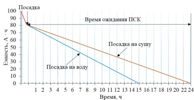
Рис. 1. Электропотребление бортовых систем возвращаемого аппарата
