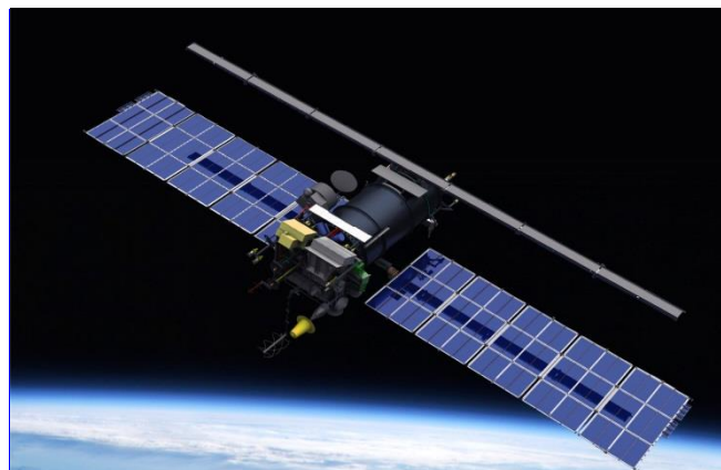
Рис. 3. Радиолокатор с синтезированной апертурой на космическом аппарате «Метеор-М» № 1
