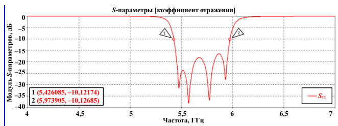
Рис. 7. График частотной зависимости коэффициента отражения S_{11} разработанной фильтр-антенны без дефектного заземляющего слоя
